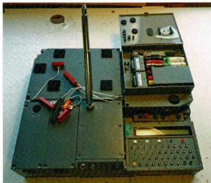
De FS-5000 was een door AEG Telefunken in 1985 ontwikkeld datacommunicatiesysteem voor het verzenden en ontvangen van gecodeerde boodschappen. Dit apparaat werd door verschillende stay behind-organisaties, waaronder de Nederlandse, gebruikt in de laatste operationele periode. In Nederland stond het systeem ook bekend onder de naam AZO-90 (Automatische ZendOntvanger 1990). - foto www.greatestcollectibles.com
