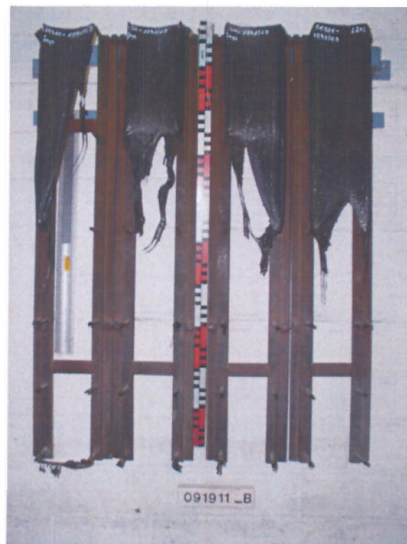
Bild 4: Aussehen des Probekörpers B nach 10-minütiger Beflammung
