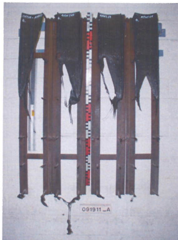
Bild 3: Aussehen des Probekörpers A nach 10-minütiger Beflammung
